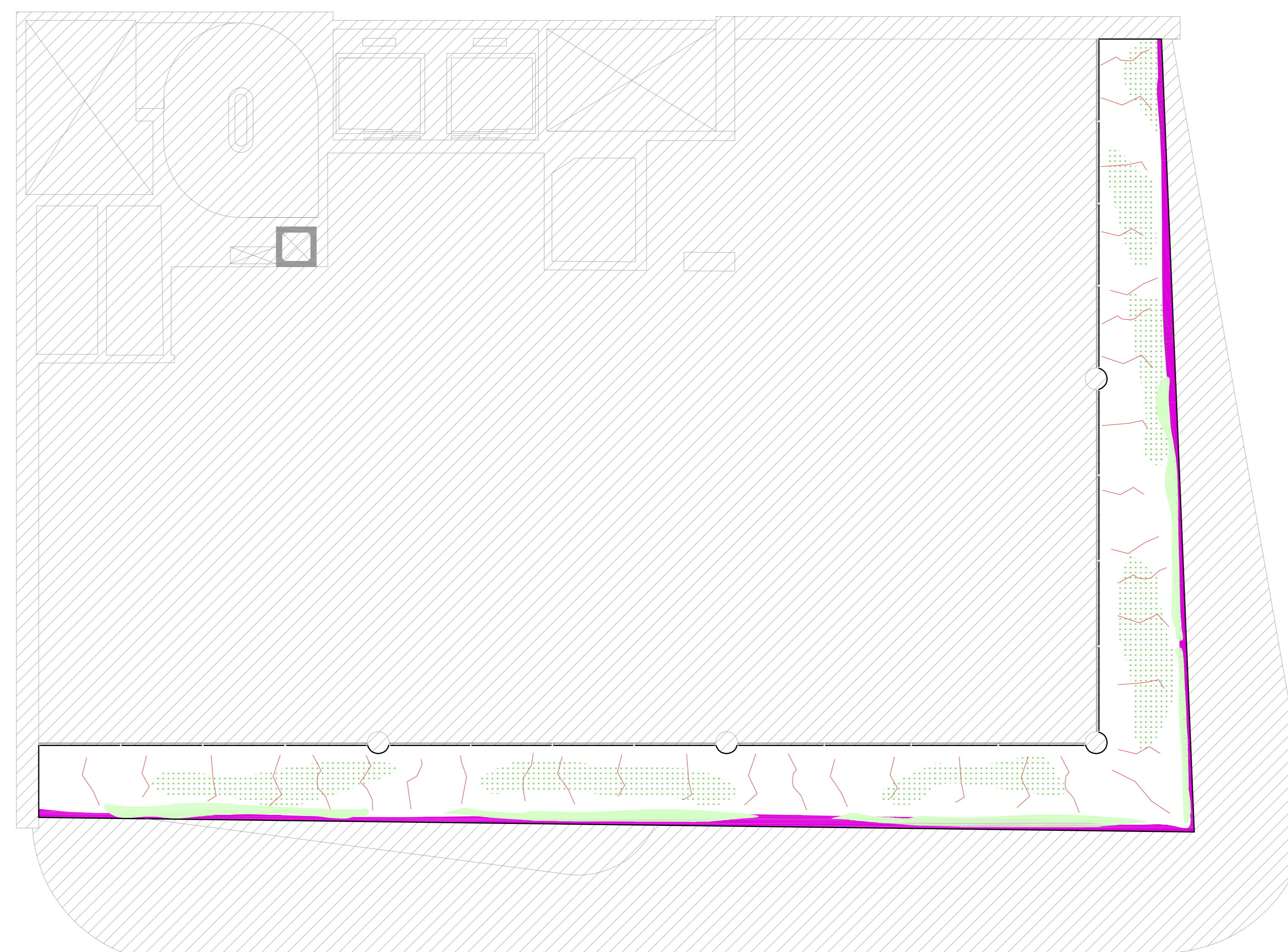
Marquise 7º pavimento - Mapeamento das Patologias Planta Esc: 1/50
