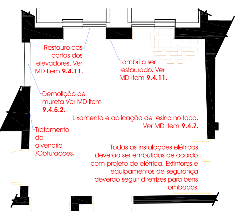
Hall Tipo - Projeto de Restauro Planta Esc: 1:50
