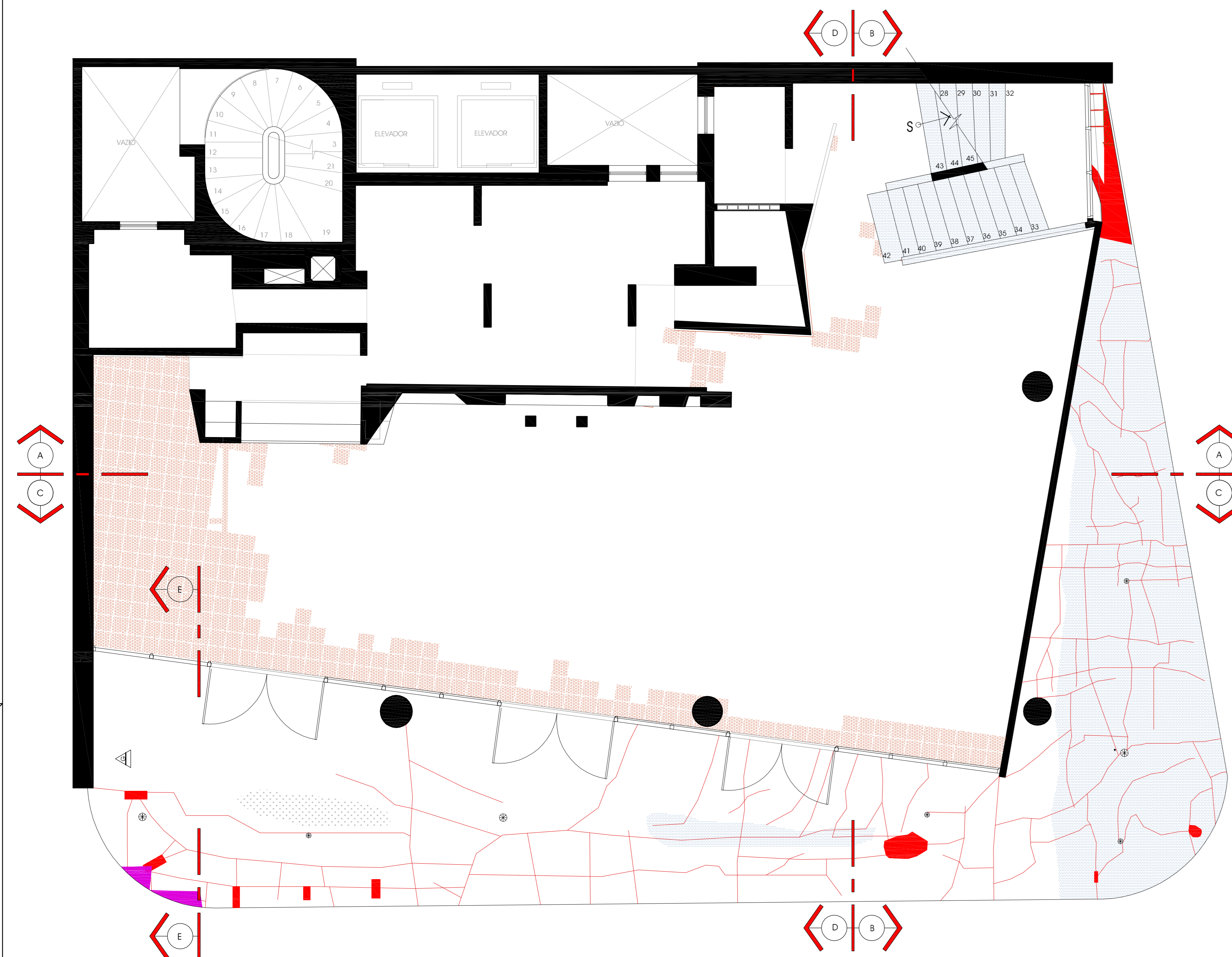
Restaurante - Mapeamento das Patologias Planta Esc: 1:50
